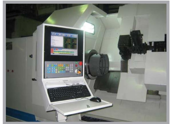
Предназначены для обработки в патроне по программе деталей типа фланцев, крышек, барабанов, дисков, колец и т.д. из конструкционных и жаропрочных сталей и сплавов на основе титана, магния, меди, алюминия с выполнением токарных операций по наружным, внутренним и торцевым поверхностям, а также сверлильных фрезерных расточных операций вращающимся инструментом параллельным и перпендикулярным оси изделия.
